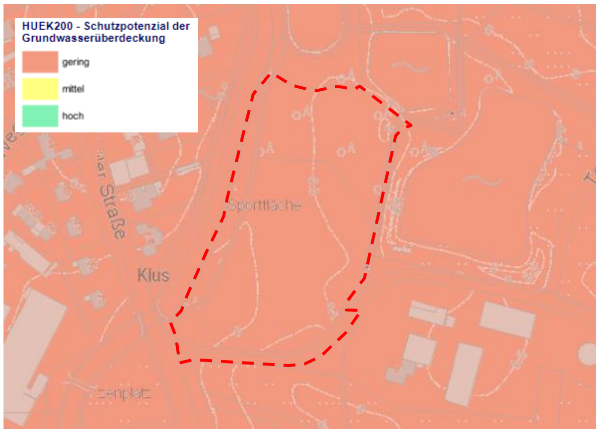
Abbildung 15: Schutzpotenzial der Grundwasserüberdeckung, unmaßstäblich (NIBIS 2024)
