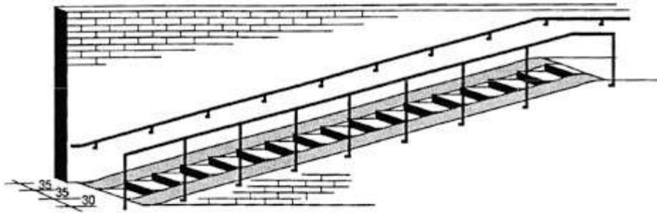
**Bild 89: Beispiel einer Unterführung mit Treppen und Schieberampen zur Führung von Fahrrädern und Kinderwagen**
